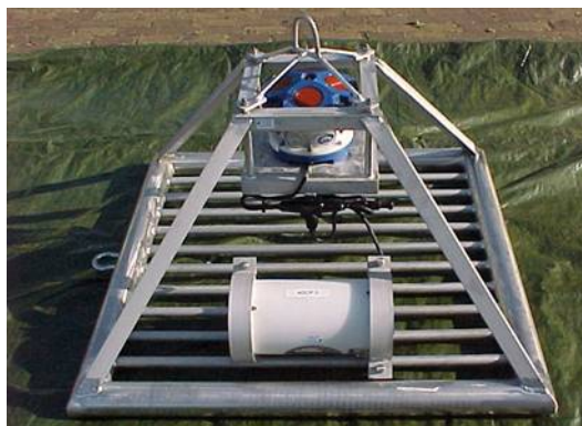
Figuur 3 ADCP geplaatst in meetframe
